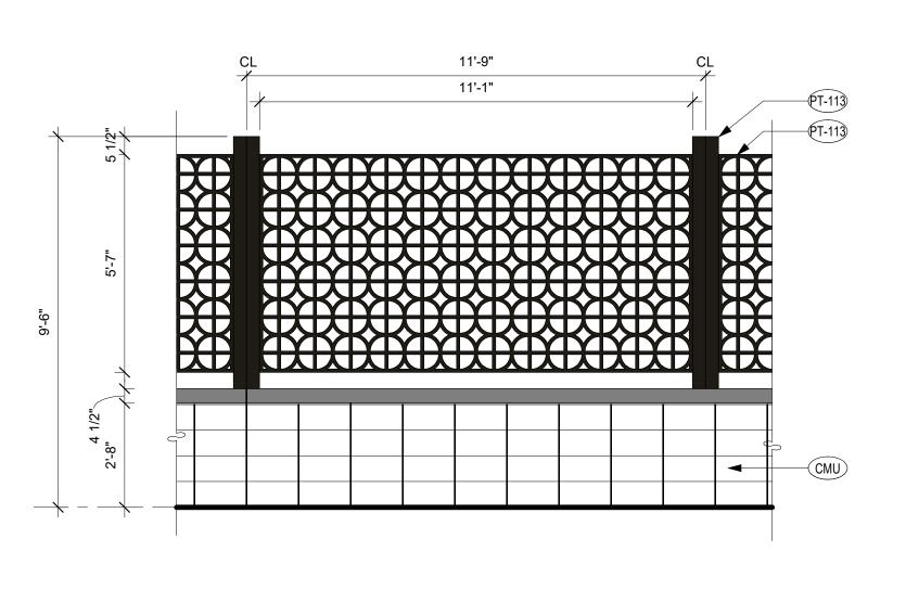
B1 SCREEN WALL ENLARGED ELEVATION
